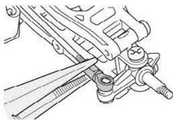
★ステアリングロッドは図のようにひねって外します。
