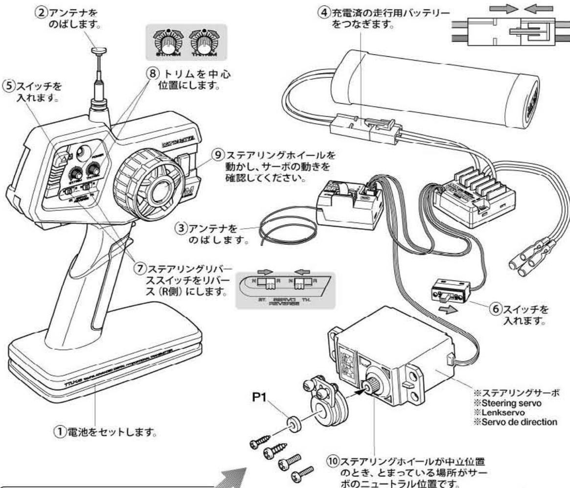
★使用するサーボの取り付け穴に合わせてビスを選びます。
