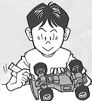
⑧ ギヤや軸受け部、サスペンションなどの可動部はグリスを注しておきましょう。
