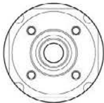
GB2 x1 デフケース Differential gear case Differentialgehäuse Carter de différentiel
