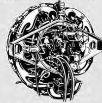
■コンチネンタル・モーターズ製R975 C4型9気筒4サイクル星型空冷エンジン ■Continental R975 C4 9-cylinder 4-cycle radial air cooled engine
